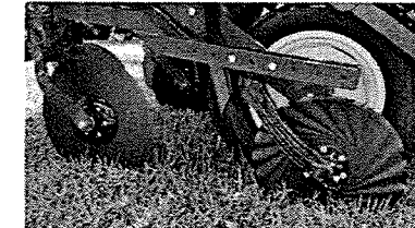
2º Disco de Corte 18" TURBO (opcional) Auxiliary coultter 18" (optional)
